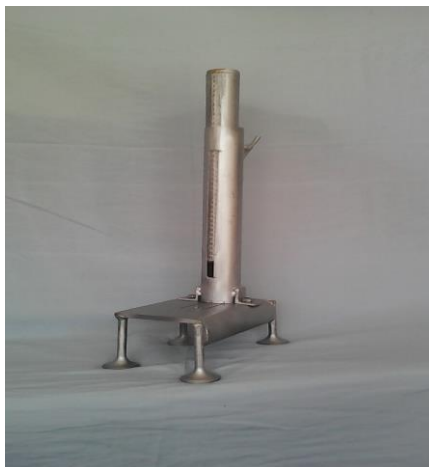
Рис. 1. Прибор для определения силы нарезки овощей.
