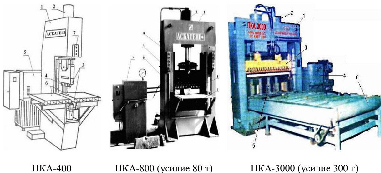
Рис. 5. Камнекольные прессы ПКА для производства колотых изделий из природного камня.
