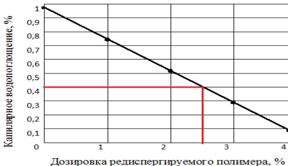
Рис. 4. Влияние редуспергуемого полимера на капиллярное водопоглощение штукатурного раствора на основе известково-песчаной смеси
