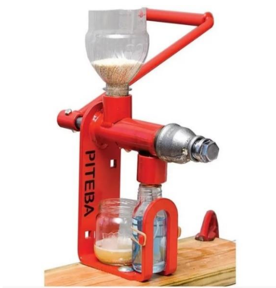
Рис. 1. Отжим сафлорового масла с помощью ручного шнекового маслопресса «PITEBA».
