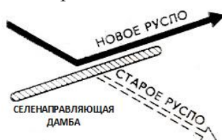
Рис. 2. Схема работы селенаправляющей дамбы
