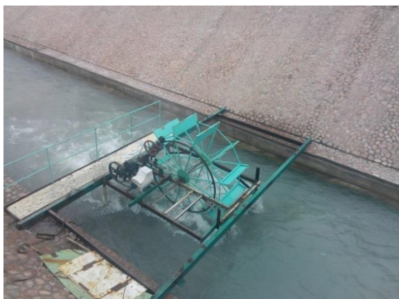
Рис. 1. МикроГЭС-1 на свободно протекающем месте потоке воды Маргелан сае (г. Фергана)
