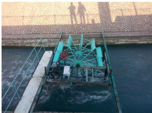
Рис. 1. МикроГЭС-1 на свободно протекающем месте потоке воды Маргелан сае (г. Фергана)
