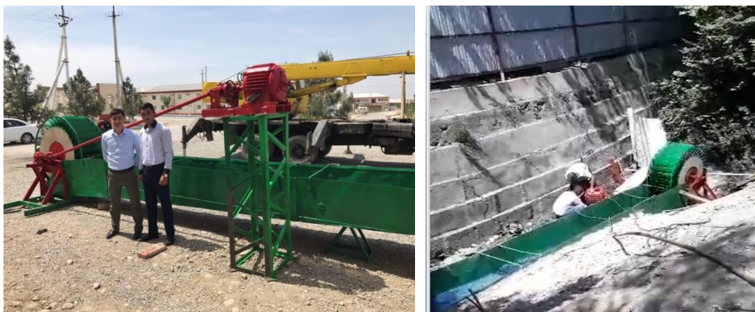
Рис.4. Общий вид микро-ГЭС с редуктором и карданной передачей от гидроагрегата к генератору на неодимовых магнитах
