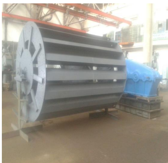
Рис.5. Общий вид гидроагрегата с редуктором
