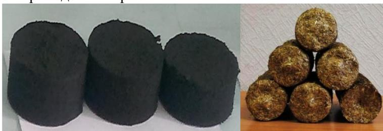
Рис.2. Брикеты, полученные измельченным тростником с угольной мелочью и без них
