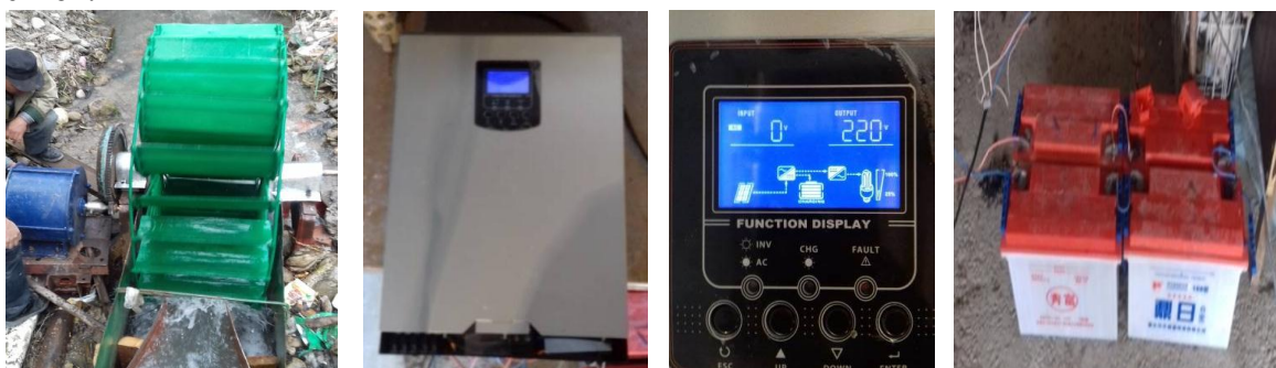
Рис. 1. Экспериментальный образец Микро-ГЭС – Чимиён и его составляющие элементы
