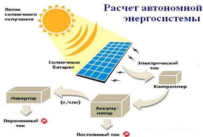
Рис. 3. Схема работы автономной системы энергоснабжения
