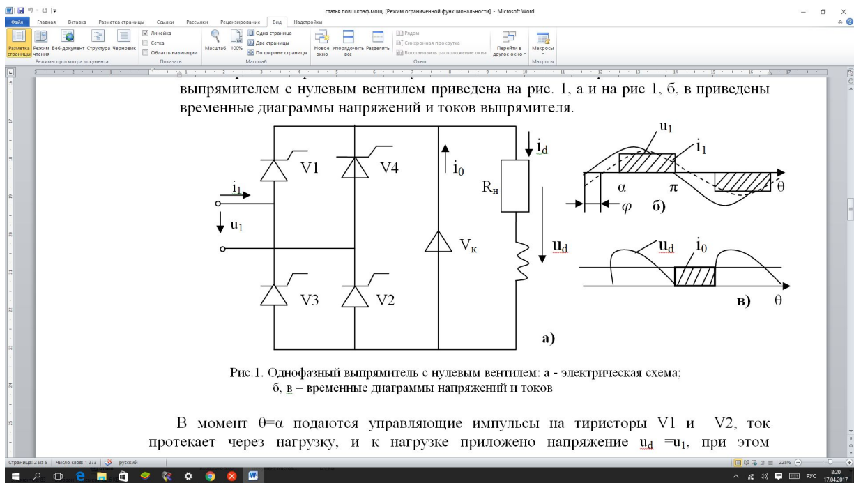
Рис.1. Однофазный выпрямитель с нулевым вентилем: а - электрическая схема; б, в – временные диаграммы напряжений и токов
