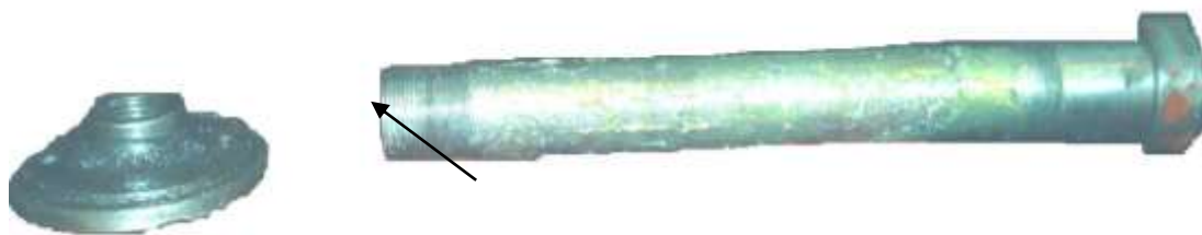
Рис. 6 Срезанная часть резьбы M22x1,5
