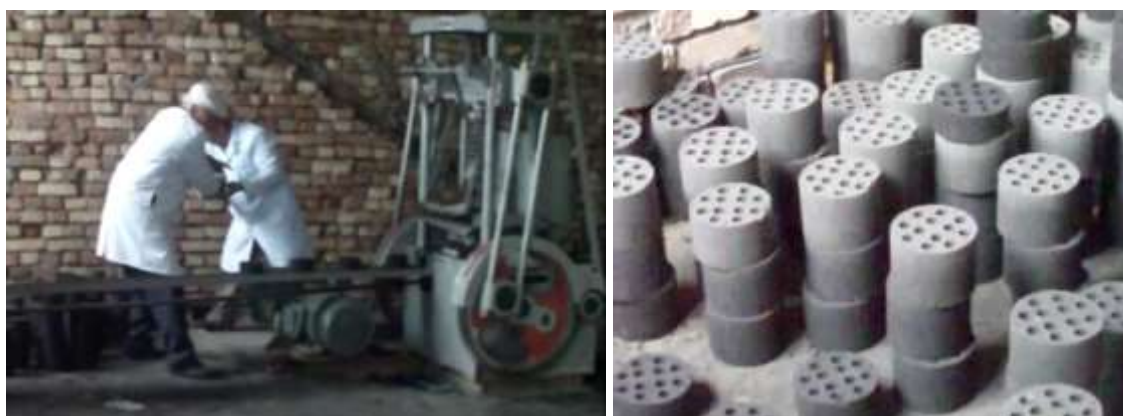
Рис.2. Уплотнение смеси на специальном прессе в пресс-форме, брикеты со сквозными дырками.
